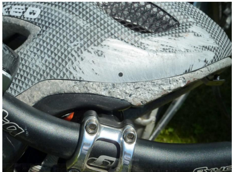
Mein Fahrradhelm nach dem Sturz. Solche Helme müssen unbedingt ausgetauscht werden! (Foto: Wenski)
